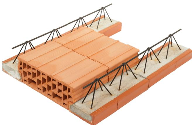
Die Deckenträger sind mit räumlicher Bewehrung verstärkt und werden in Längenmodulen von 250 mm hergestellt. Bei einer Länge von 1,5 m bis 6,25 m haben sie eine Höhe von 175 mm und bei einer Länge von 6,5 m bis 8,25 m haben sie eine Höhe von 230 mm. Die Deckeneinlagen MIAKO werden für einen Achsabstand der Deckenträger von 500 und 625 mm, in drei Grundhöhen von 150, 190 und 230 mm hergestellt. Darüber hinaus werden zusätzliche niedrige Deckeneinlagen mit einer Höhe von 80 mm hergestellt.
