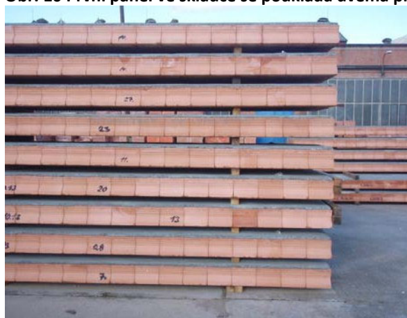
Obr. 11 Proklady mezi jednotlivými panely se umísťují ve svislici nad sebou
