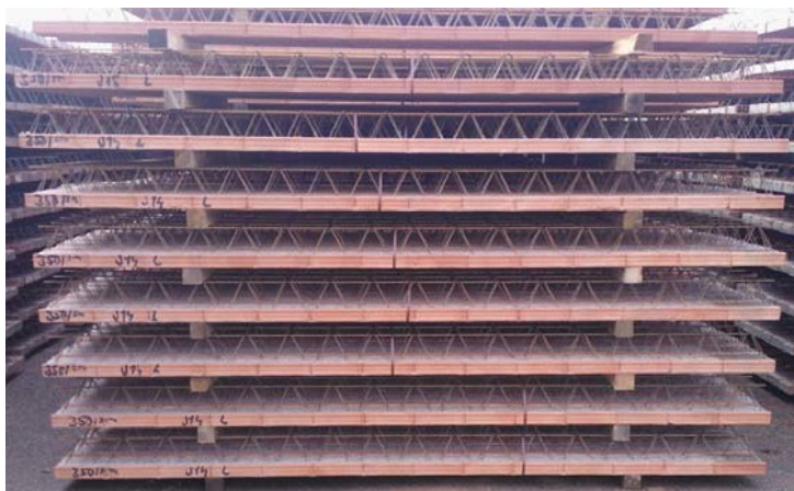
Obr. 8 Správná poloha umístění prokladů Obr. 7 Ukázka slohy stropních nosníků
